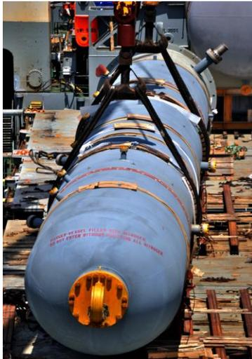
**Fotografía 29 Manejo Carga de Proyectos – Reactor para REFICAR**
