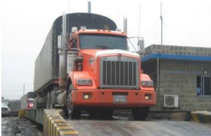
Fotografía 2 Pesaje de un tracto camión al ingresar a las instalaciones.
