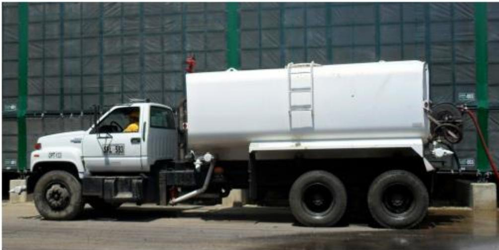
Fotografía 3 Humectación de vías con el carro tanque dotado de flauta con boquillas K7.
