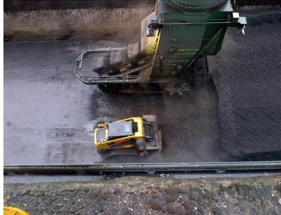
**Ilustración 22 Descargador de barcasas de cangilones – FAM.**
