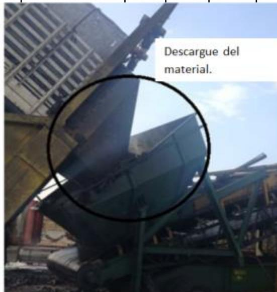
Fotografía 12 Descargue del petcoke a apilador móvil.
