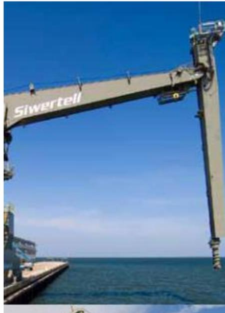
**Ilustración 24 Descargador de barcas tornillo - SIWERTEEL**
